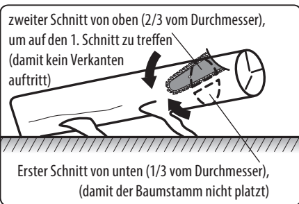
Baumstamm an einem Ende abgestützt, Abb. 14
