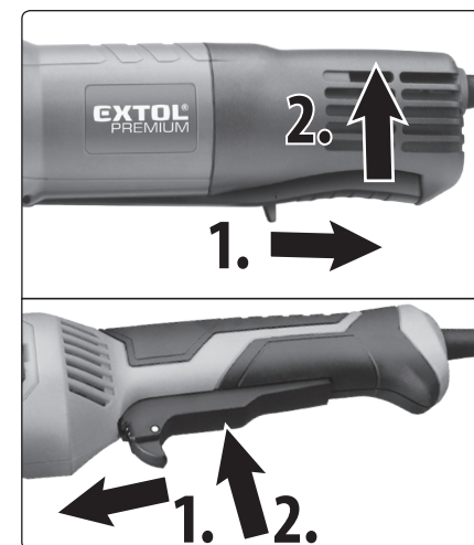
Abb.15; Schritt1. Entriegelung, Schritt 2. Einschaltung
